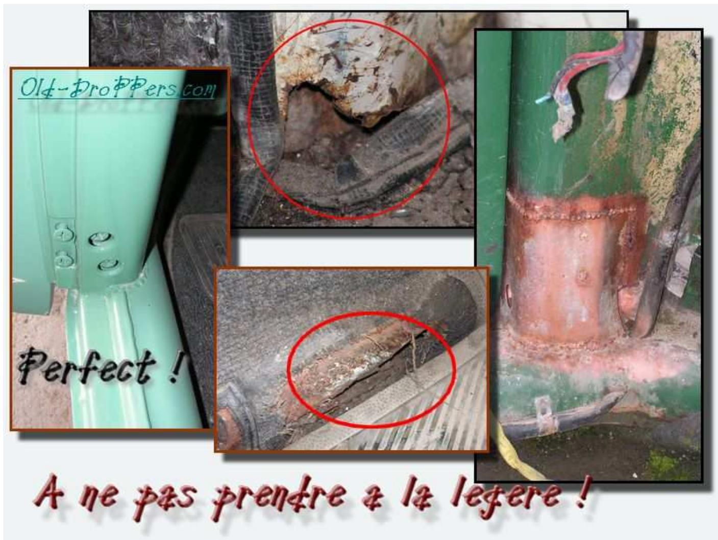
C'est le moment de soulever les tapis pour voir si l'isolant d'origine (grosses plaques de goudron collées) est toujours là et dans quel état. Là aussi, si la voiture laisse passer de l'humidité ou de l'eau, ces isolants s'imbibent et accélèrent l'oxydation de la tôle.
